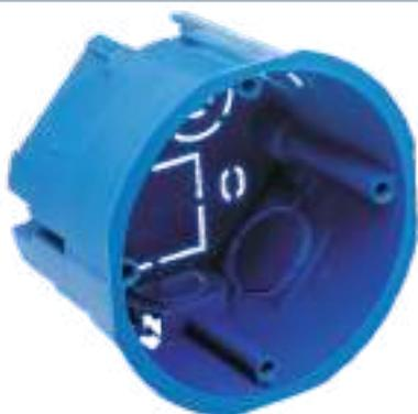
Коробка установочная (подрозетник) предназначена для установки розеток, выключателей и других электроустановочных изделий в кирпичные и бетонные стены. Подрозетники C3E3 могут соединяться между собой при помощи кабель-канала (поставляется отдельно), обеспечивая межосевое расстояние 71мм, и образуют при этом закрытый соединительный канал для проводки. В отличие от стандартного C3M2, на данном подрозетнике отсутствуют два самореза размером - 3x20мм (обозначение BC). Цвет синий. Материал пластик.
