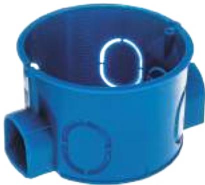
Коробка установочная (подрозетник) предназначена для установки розеток, выключателей, и других электроустановочных изделий в кирпичные и бетонные стены. Подрозетники соединяются между собой, обеспечивая межосевое расстояние 71мм и образуют при этом закрытый соединительный канал для проводки. Без двух саморезов для крепления электроустановочных изделий в подрозетнике, размером - 3x20мм. (обозначение BC). Материал пластик. Цвет синий.
