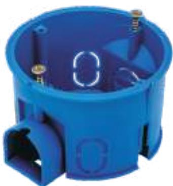
Коробка установочная (подрозетник) предназначена для установки розеток, выключателей и других электроустановочных изделий в кирпичные и бетонные стены. Подрозетники соединяются между собой, обеспечивая межосевое расстояние 71мм и образуют при этом закрытый соединительный канал для проводки. Подрозетник укомплектован двумя саморезами размером - 3x20мм. Цвет синий. Материал пластик.
