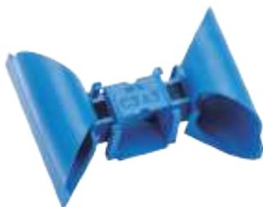
Коробка устаноавочная (подрозетник) предназначена для установки розеток, выключателей и других электроустановочных изделий в кирпичные и бетонные стены. Подрозетники C3E3 могут соединяться между собой при помощи кабель-канала (поставляется отдельно), обеспечивая межосевое расстояние 71мм, и образуют при этом закрытый соединительный канал для проводки. В отличие от стандартного C3M2, на данном подрозетнике отсутствуют два самореза размером - 3x20мм (обозначение BC). Цвет синий. Материал пластик.
