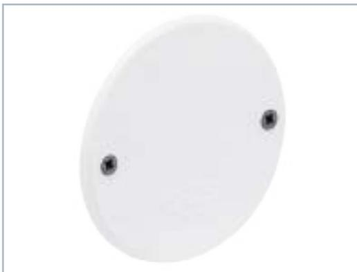
Крышка предназначена для установки на подрозетники. Устанавливается при помощи двух саморезов размером 3x20мм, которые не входят в комплект поставки. Цвет белый (001). Материал пластик.
