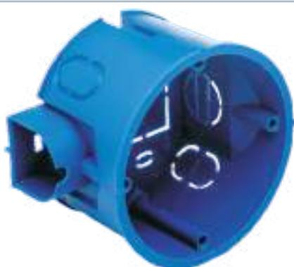
Коробка установочная (подрозетник) предназначена для установки розеток, выключателей и других электроустановочных изделий в кирпичные и бетонные стены. Подрозетники соединяются между собой, обеспечивая межосевое расстояние 71мм и образуют при этом закрытый соединительный канал для проводки. В отличие от стандартного C3M3, на данном подрозетнике отсутствуют два самореза размером - 3x20мм (обозначение BC). Цвет синий. Цвет синий. Материал пластик.
