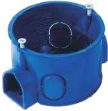
Коробка установочная (подрозетник) предназначена для установки розеток, выключателей, и других электроустановочных изделий в кирпичные и бетонные стены. Подрозетники соединяются между собой, обеспечивая межосевое расстояние 71мм и образуют при этом закрытый соединительный канал для проводки. Для крепления в подрозетнике электроустановочных изделий он укомплектован двумя саморезами размером - 3x20мм. Цвет синий. Материал пластик.
