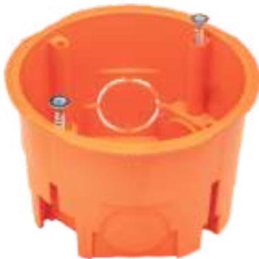
Коробка установочная (подрозетник) предназначена для установки розеток, выключателей, и других электроустановочных изделий в кирпичные и бетонные стены. Подрозетники СЗМ2 могут соединяться между собой при помощи кабель-канала (поставляется отдельно), обеспечивая межосевое расстояние 71мм, и образуют при этом закрытый соединительный канал для проводки. Имеются два самореза размером - 3x20 мм. для крепления в подрозетнике электроустановочных изделий. Цвет оранжевый. Материал негорючий пластик.
