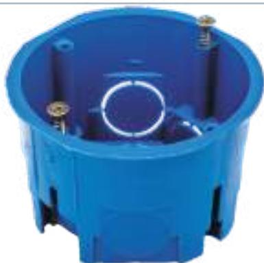
Коробка установочная (подрозетник) предназначена для установки розеток, выключателей и других электроустановочных изделий в кирпичные и бетонные стены. Подрозетники могут соединяться между собой при помощи кабель-канала (поставляется отдельно), обеспечивая межосевое расстояние 71мм, и образуют при этом закрытый соединительный канал для проводки. Имеются два самореза размером - 3x20мм, для крепления в подрозетнике электроустановочных изделий. Цвет синий. Материал пластик.
