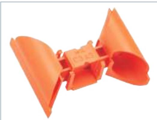
Предназначен для соединения подрозетников СЗМ2, СЗЕ3 и обеспечения межосевого расстояния 71 мм между ними. При этом СЗА3 образует закрытый канал для проводки. Цвет оранжевый. Материал негорючий пластик.
